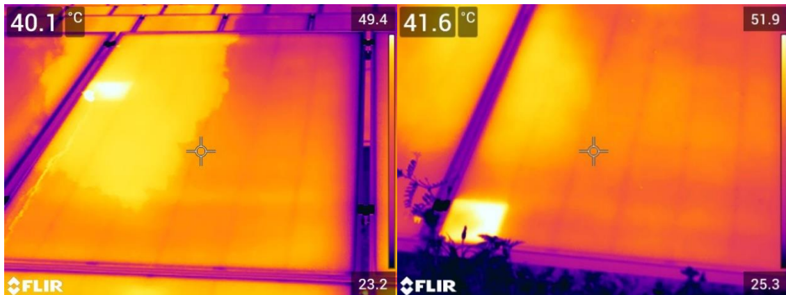
70. ábra: Napelempanelekről készült hőkamerás felvételek, koszhatás (a) és növényzet okozta árnyékhatás (b) következményeinek detektálására vonatkozóan.
