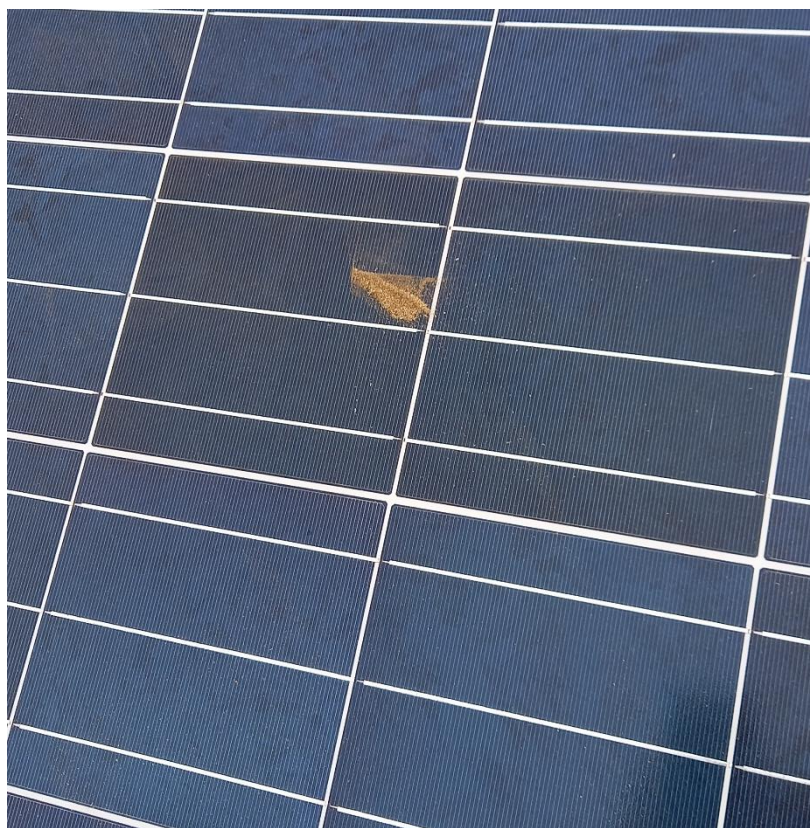
84. ábra: Növényi eredetű, koncentrált szennyezőanyag lerakódása a napelem felületén.
