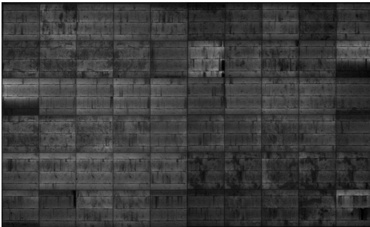
87. ábra: A PV46740 jelű napelem panel elektrolumineszcencia felvétele.
