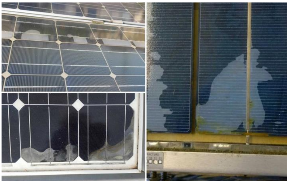
67. ábra: A delamináció, vagy rétegleválás jelensége napelemeken.
