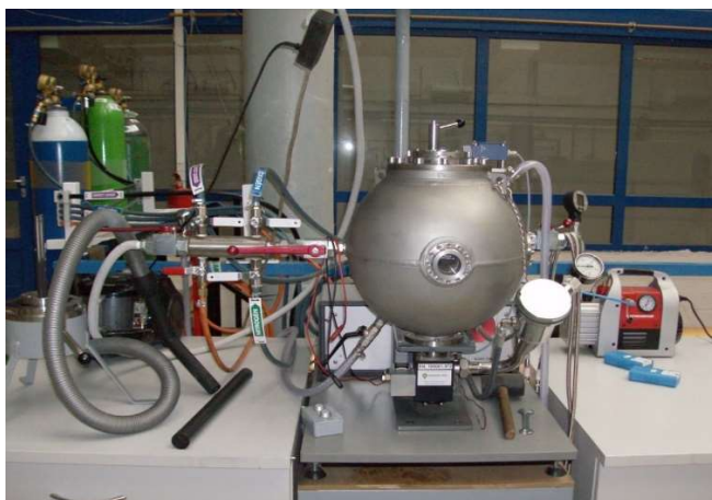
1.4. ábra 20 liter űrtartalmú Kühner robbantókamra és összeállítási vázlat
