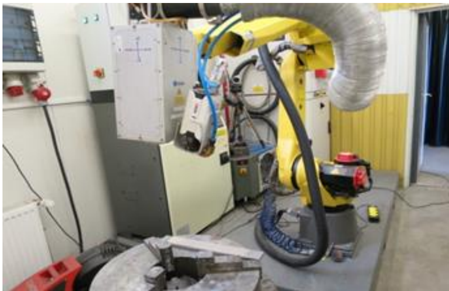
8. ábra. A szórt réteg újraolvasztása Fanuc robotra szerelt kevert lézeres hőforrással.
