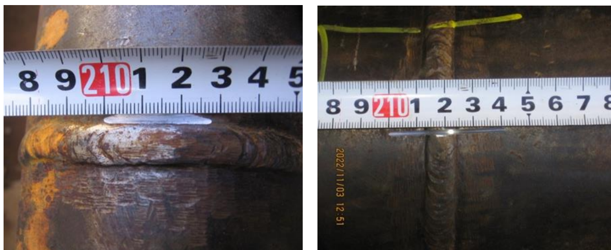
8. ábra. Kerület irányú és axiális irányú mesterséges bemetszések a vizsgált körvarratokban.
