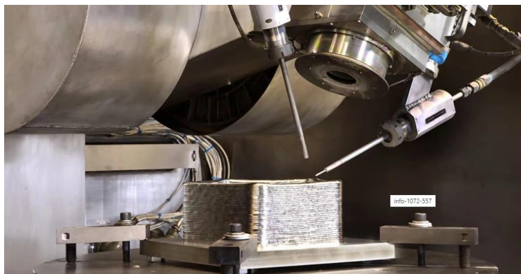
5. ábra. Elektronsugár vezérelt DED eljárás [6].
