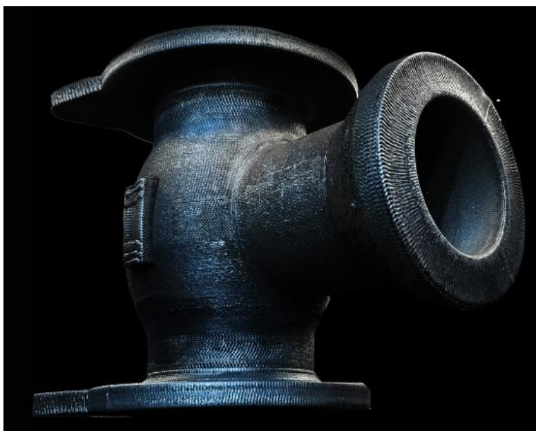
11. ábra. Az MX3D WAAM technológiával gyártott T-idom [13].
