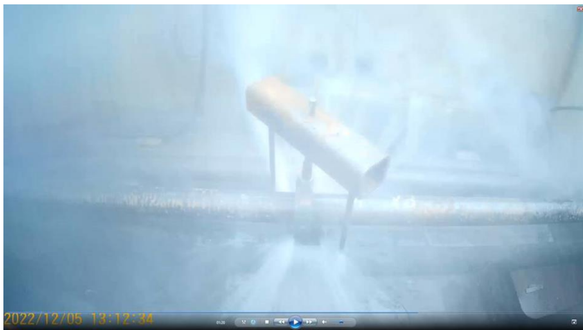
10. ábra. Az Y8 jelű kísérleti csőszakasz tönkremenetelének pillanata a repesztővizsgálat során – a tönkremenetel helye: körvarraton átmenő axiális bemetszés.
