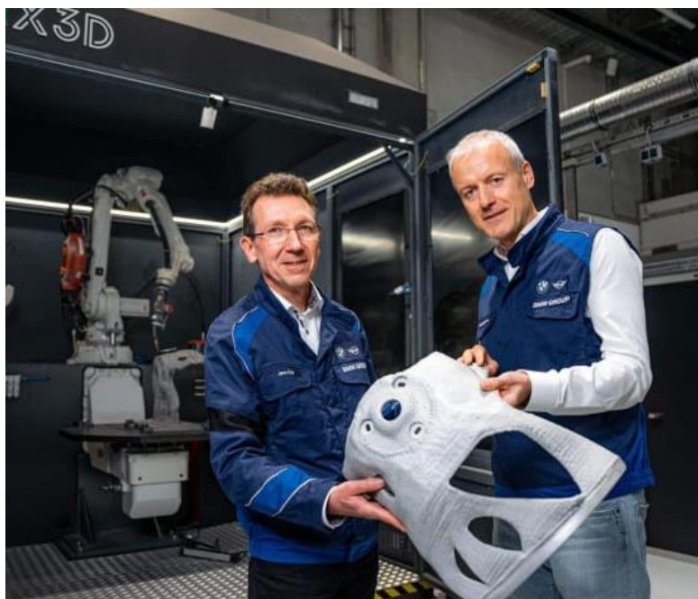
9. ábra. A BMW WAAM technológiával gyártott alkatrésze [12].
