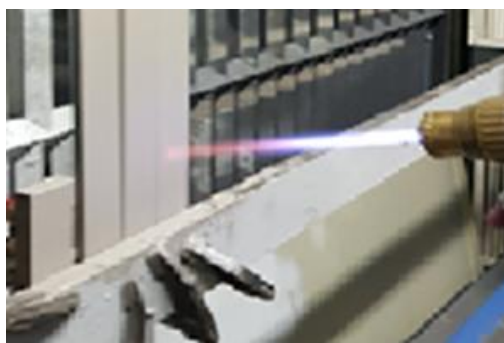
5. ábra. Próbatestek készítése nagysebességű (HVOF) szórással.
