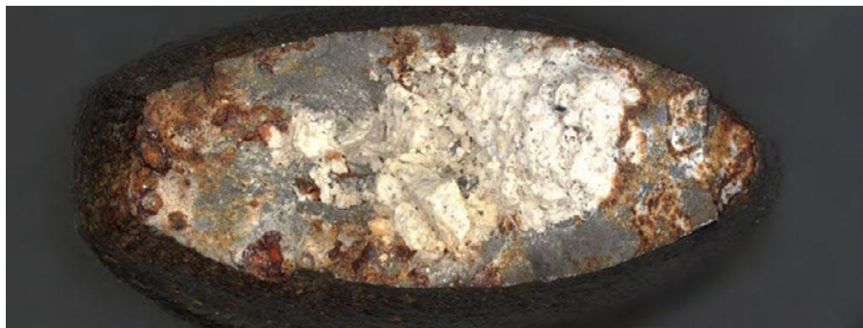
9. ábra. Feszítőhuzal törésfelület habarcsztapadással [3].
