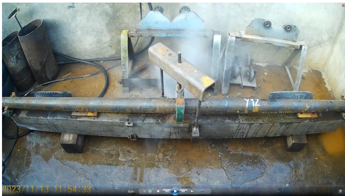
11. ábra. Az Y12 jelű kísérleti csőszakasz tönkremenetelének pillanata a repesztővizsgálat során – a tönkremenetel helye: kerület irányú bemetszés.
