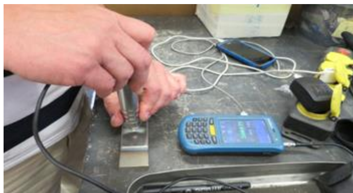
10. ábra. Keménységértékek mérése ultrahangos keménységmérővel.
