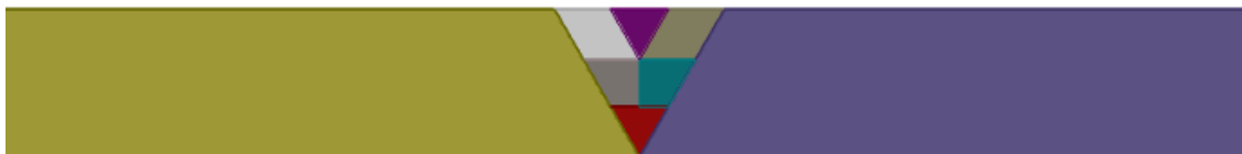
3. ábra. A varratsorok felépítése (2D vázlat).
