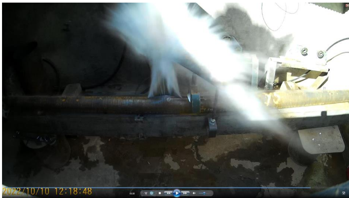
9. ábra. Az Y5 jelű kísérleti csőszakasz tönkremenetelének pillanata a repesztővizsgálat során – a tönkremenetel helye: csőpalást.
